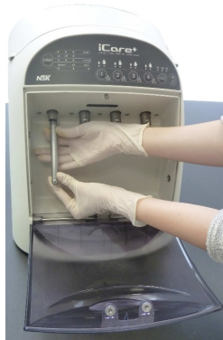
Fig.15 – Visser la bague de maintien
